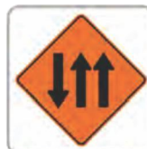
TRES CARRILES DE TRANSITO, UNO EN CONTRAFUJO
