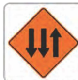
TRES CARRILES DE TRANSITO, DOS EN CONTRAFUJO
